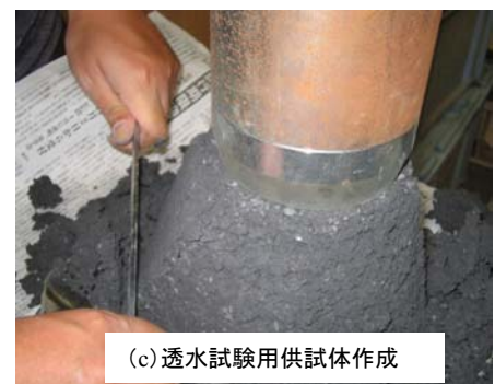
図-2 変形実験後の混合土から供試体の採取状況
