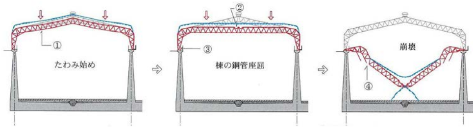
図 2-6 屋根崩壊過程推測図
