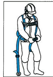
③ 股の間に腿ベルトを通したあと、再び腿バックルを装着し、身体全体にたるみがないよう腿バックルで腿ベルトの長さを調整する。
