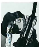
④ ロープ挿入管に親網を入れる。
