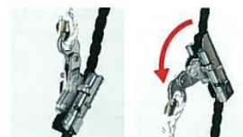
● 持ち手を引き、ロリップが下がることなく親網上で停止するのを確認する。
