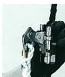
⑥ ロックピンが出ないように安全装置が閉まっているか確認して取付完了。
