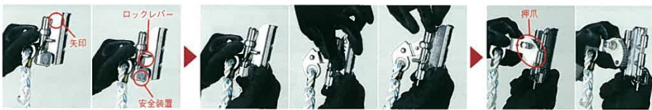
① ロリップを、本体の矢印を上に向けて持つ。 ② 安全装置を起こし、ロックレバーを溝に沿って下へ引く。
