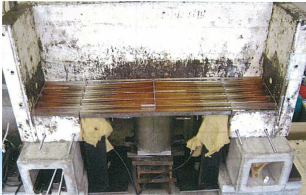
集水用底盤と設置状況
