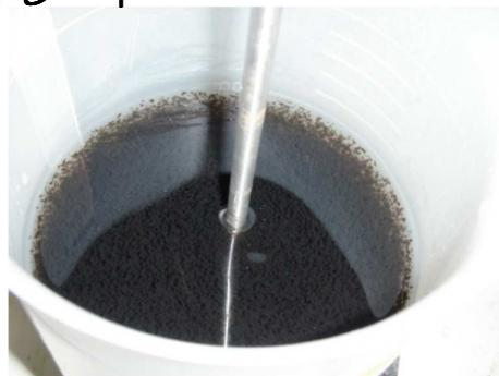
キレートと塩化第二鉄が反応し、硫化物と思われる固形物が生成
